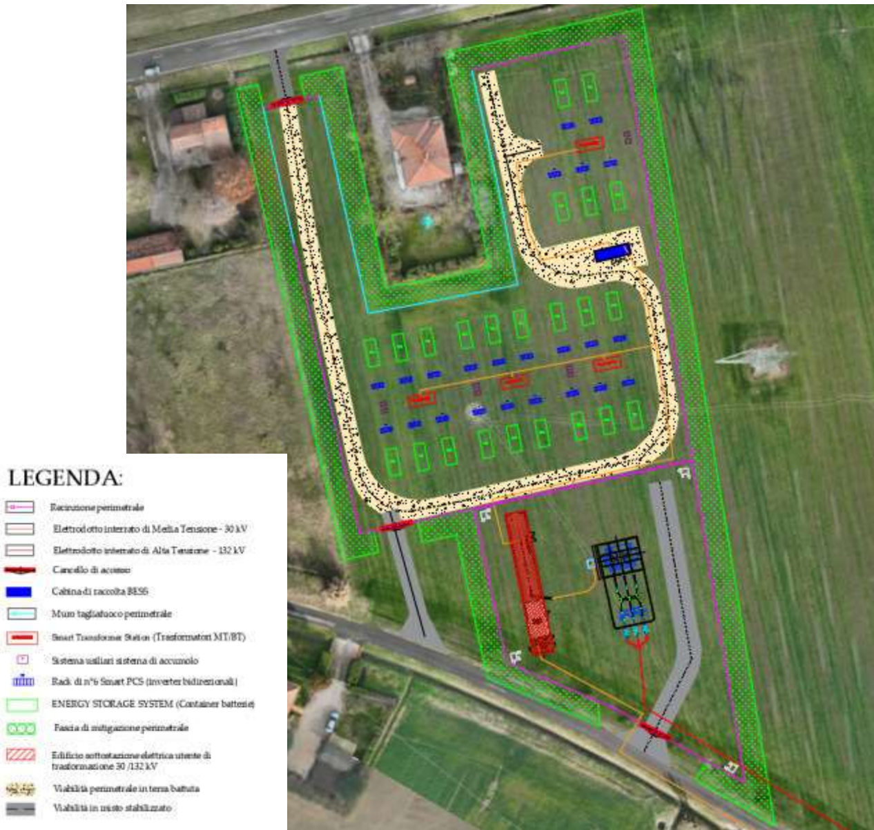
Sistema di accumulo e Sottostazione elettrica utente
